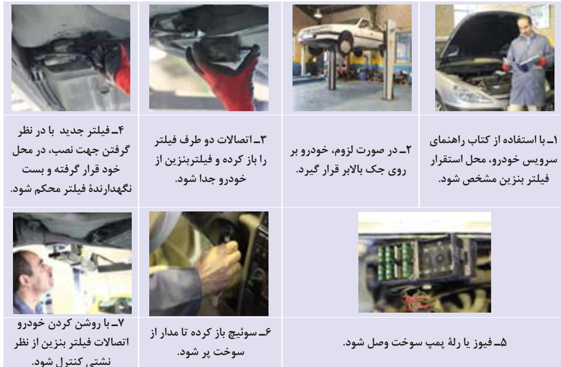
شکل ۳-۳۵ روش تعویض فیلتر بنزین
