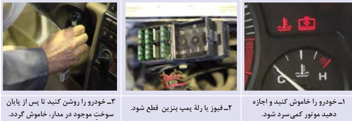
شکل ۳-۳۴ روش تخلیه فشار مدار سوخت رسانی
