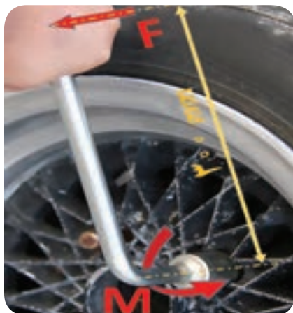
شکل ۱۰- باز کردن پیچ چرخ خودرو توسط آچار چرخ
