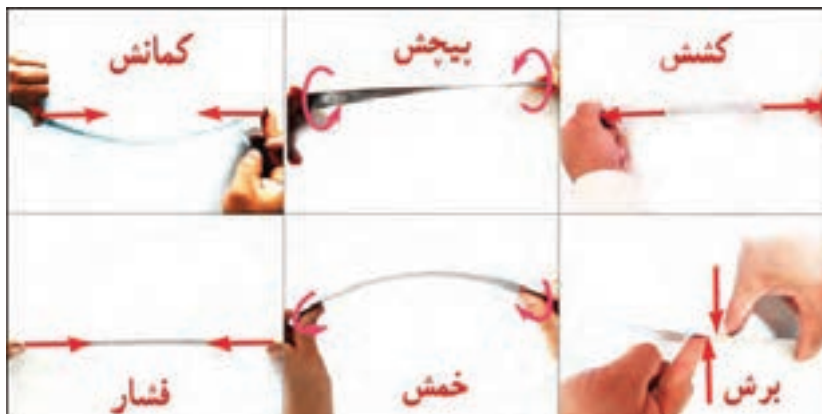
شکل ۴- انواع بارگذاری روی خط‌کش فلزی
