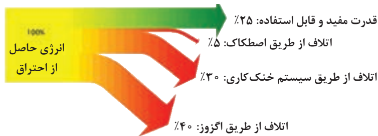
شکل ۲۵- راندمان حرارتی موتور
