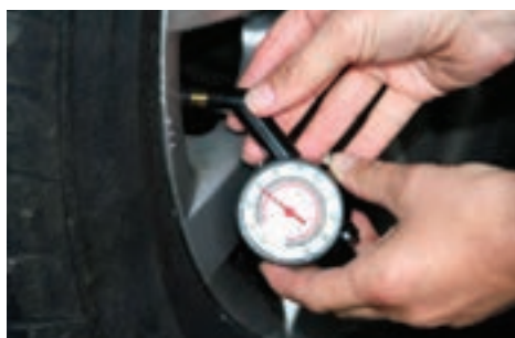
شکل ۳- فشارسنج باد تایر
