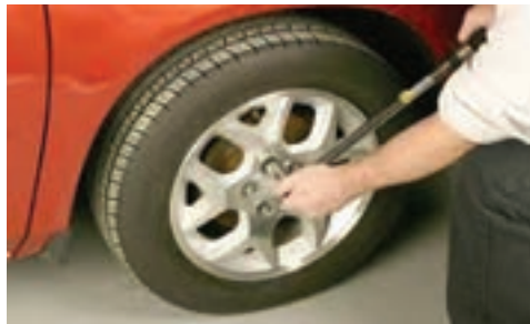
شکل ۴- گشتاور لازم برای سفت کردن چرخ
