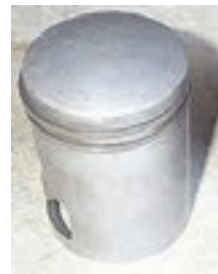
الف) پیستون قدیمی با وزن بیشتر
