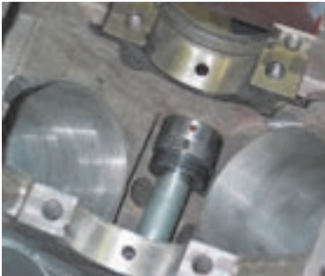
تعویض بوش‌های میل سوپاپ شکل ۱۶۱-۲
