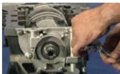
باز کردن پیچ های پمپ روغن
