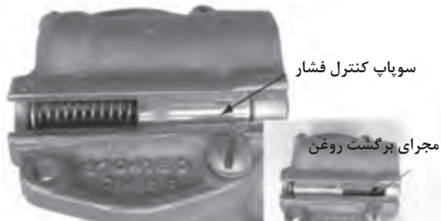
بررسی سلامت اجزای سوپاپ کنترل فشار
