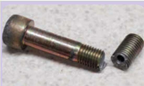
شکل ۳۱- یک پیچ بریده شده بر اثر بارگذاری پیچشی
