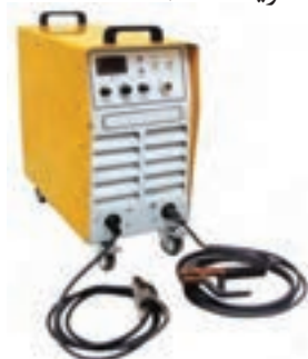
شکل ۱۳- ترانسفورماتور جوش برق
