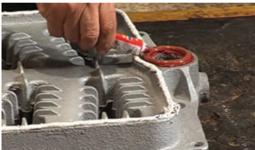
شکل ۲۰- استفاده از اورینگ به جای بوش
