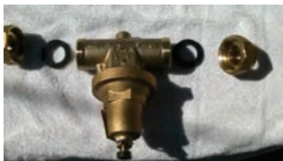
شکل ۱۹- شیر فشار شکن دیافراگمی
