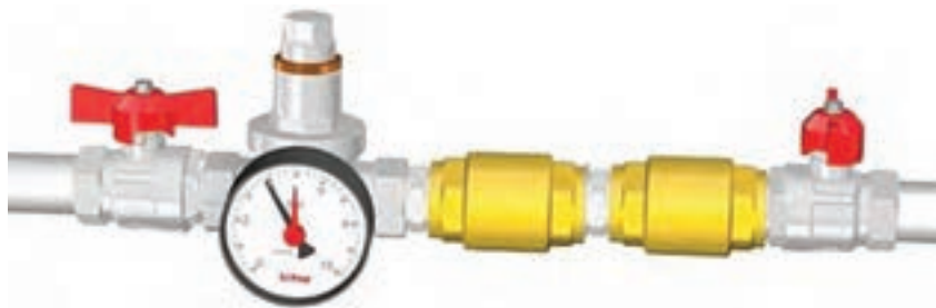
شکل ۱۷- مدار تغذیه سیستم گرمایش
