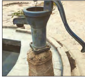
شکل ۲- تلمبه آب (سیلندر بیستونی قدیمی)
