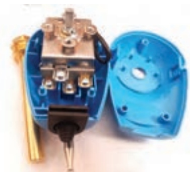
شکل ۳۶- قسمت داخلی ترموستات دیگ
