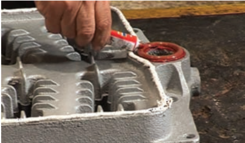
شکل ۲۰- استفاده از اورینگ به جای بوش
