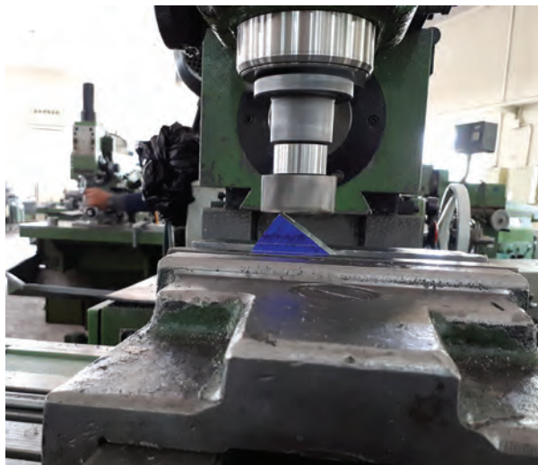
شکل ۱۷- خط کشی و بستن قطعه در گیره
