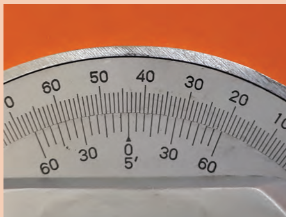
شکل ۱۴- اندازه گیری زاویه باز قطعه کار
