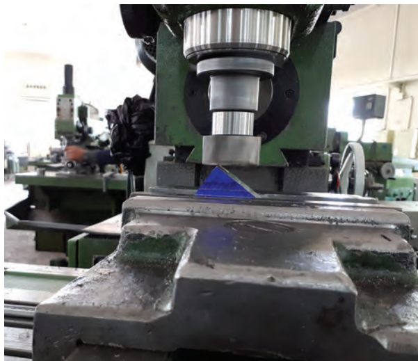
شکل ۱۷- خط کشی و بستن قطعه در گیره
