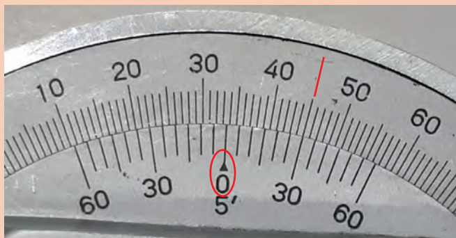
شکل ۱۲- اندازه تنظیمی با زاویه‌سنج
