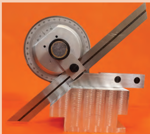
شکل ۱۴- اندازه گیری زاویه باز قطعه کار
