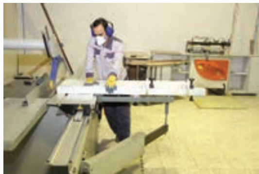
شکل ۷۶- برش توسط دستگاه پانل بر
