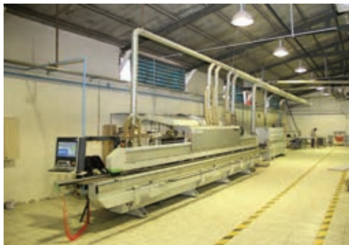
شکل ۱۲- نحوه اتصال مکنده‌های ثابت
