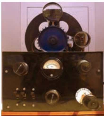
تصویر ۲۵ دستگاه پل نیپکو که منجر به اختراع تیویزیون شد
