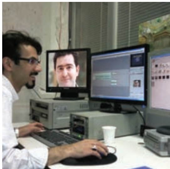
تصویر ۲۶ تدوین با دستگاه بتاکم
