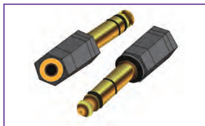
تصویر ۸۰- جک بُن استریو- نان سیمتریک (آسیب‌پذیر است و سریعاً تحت شکار نویز قرار می‌گیرد)
