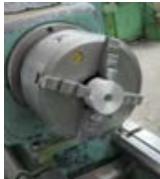
ب: بستن قطعه گرد در چهار نظام
