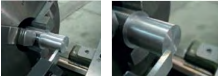
الف: مماس کردن رنده به پیشانی کار ب: حرکت طولی برای موقعیت شیاری
