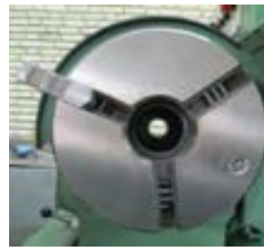
الف: استقرار فک روی پیچ ارشمیدس
