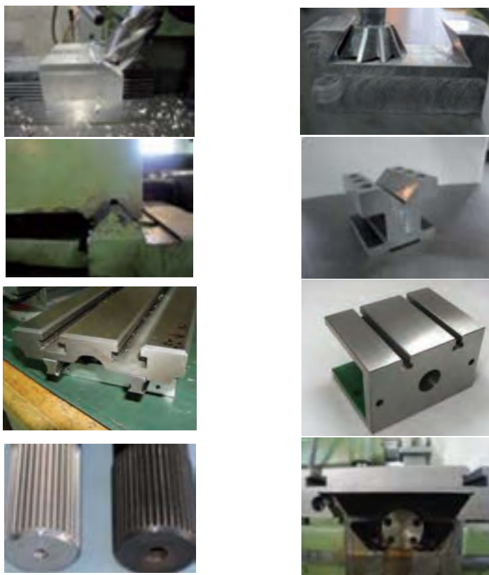
شکل ۳-۱۶: نمونه‌هایی از سطوح زاویه‌ای و شیارهای متنوع
