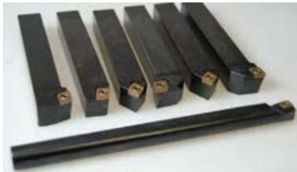
شکل ۲-۲۰: تیغچه بسته شده در نگه دارنده (هولدر)
