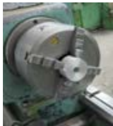
ب: بستن قطعه گرد در چهار نظام
