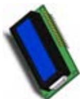
LCD کاراکتری برای نمایش اطلاعاتی مانند فاصله
