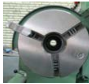
الف: استقرار فک روی پیچ ارشمیدس
