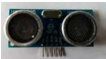
تصویر ماژول فاصله سنج SRF۰۵ آلتراسونیک.
