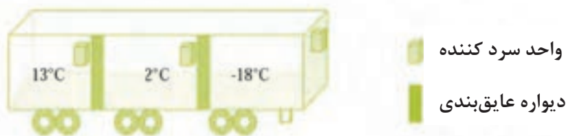
شکل ۲۰- نمای شماتیک از کانتینر با دماهای مختلف پشت سرهم
