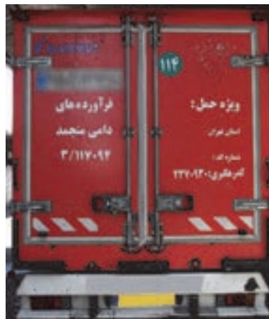
شکل ۳۴- پلاک مخصوص وسایل نقلیه حمل مواد فاسدشدنی
