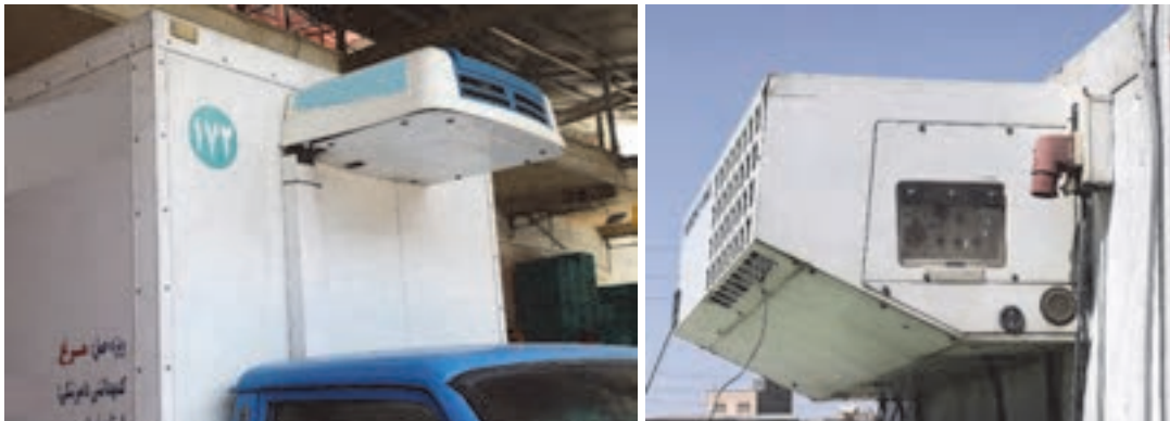
شکل ۲۱- تجهیزات سرمایشی نصب شده بر روی وسیله‌نقلیه
