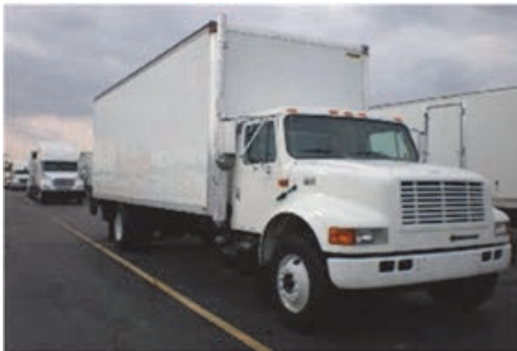
شکل ۸- کامیون با اتاق عایق‌بندی شده
