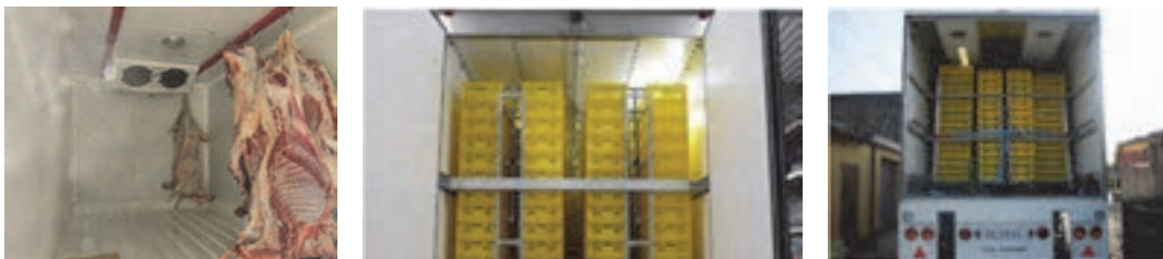
شکل ۲۲- نمونه هایی از مهار بارهای فاسدشدنی
