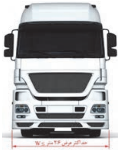
شکل ۳- حداکثر عرض تعیین شده برای وسایل نقلیه
