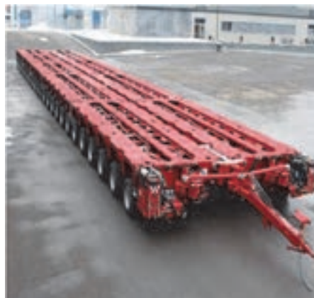
شکل ۱۴- نمونه‌ای از بوژی
