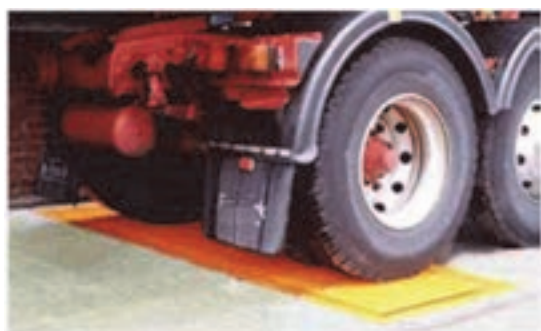
شکل ۳- باسکول محورکش ثابت
