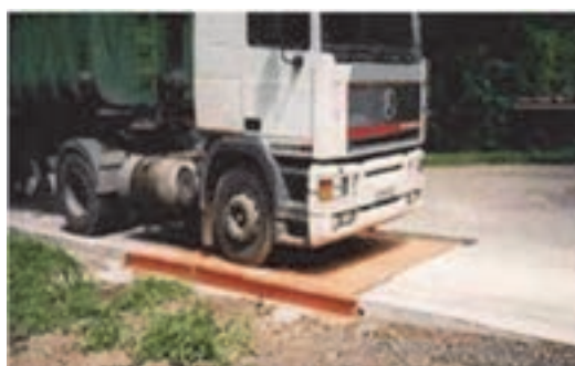
شکل ۳- باسکول محورکش ثابت
