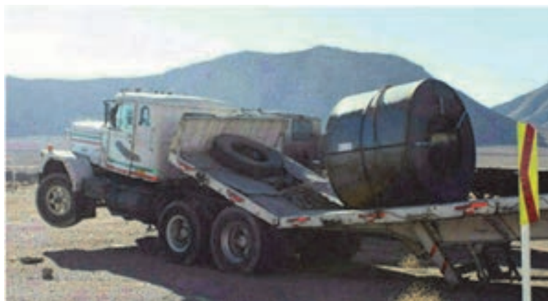
شکل ۲- عدم توزیع مناسب بار بر گروه‌های محوری
