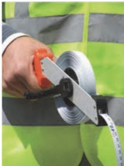
شکل ۱۶- متر کمری ۷/۵ متری و متر فلزی ۵۰ متری
