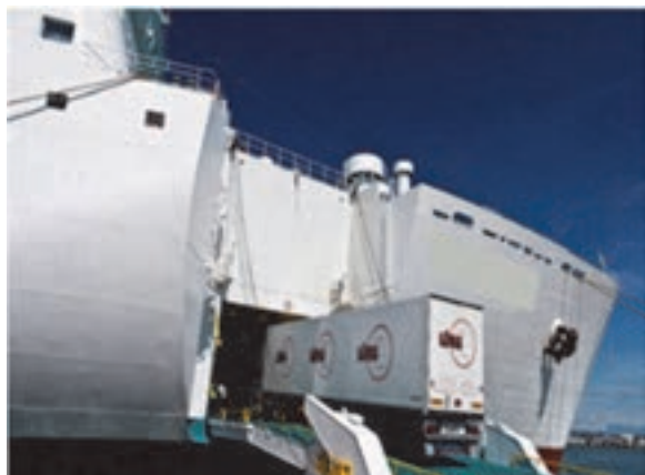
شکل ۶- روش حمل ترکیبی رو - رو (Roll on - Roll off)
