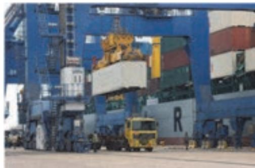
شکل ۹- بارگیری از کشتی به کامیون با جرثقیل
