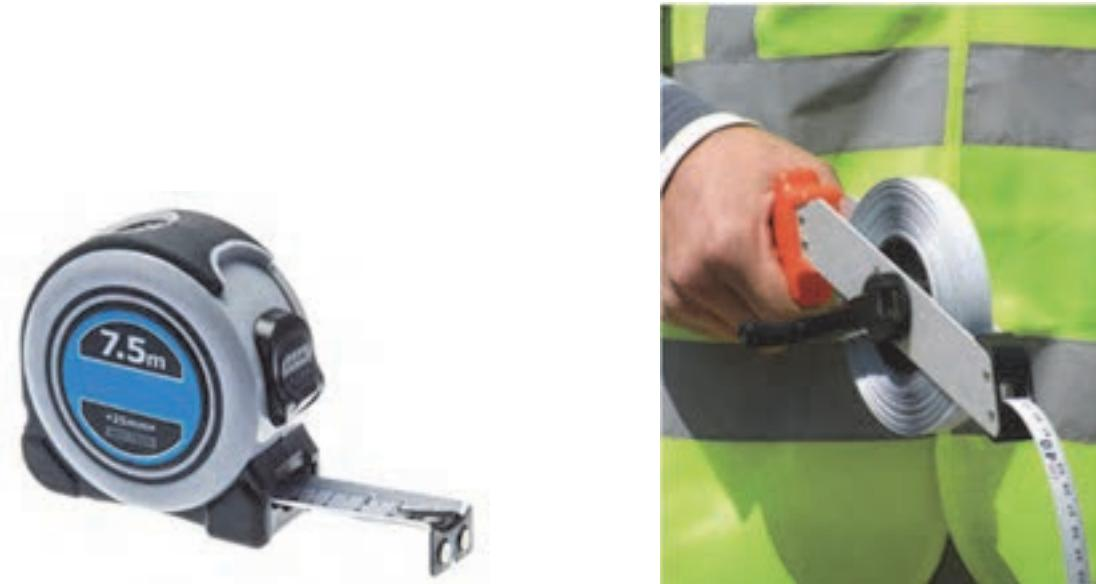
شکل ۱۶- متر کمری ۷/۵ متری و متر فلزی ۵۰ متری
