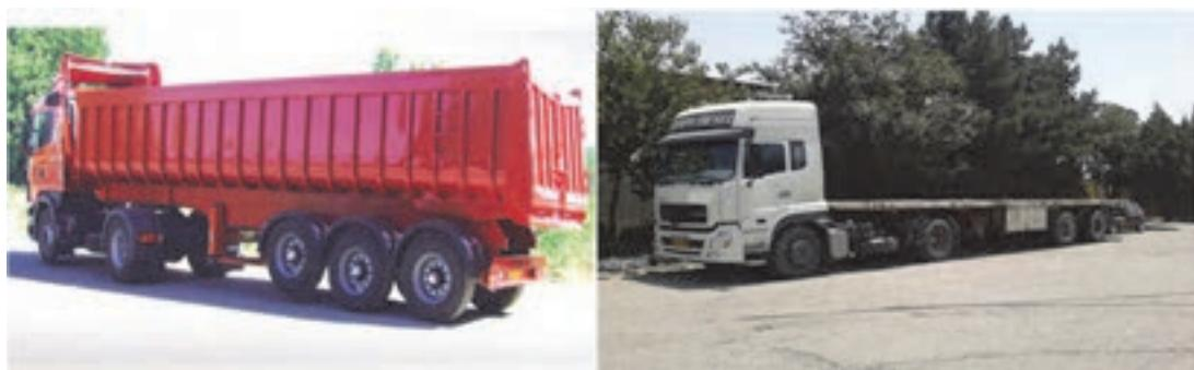
شکل ۲۱- تریلی چهار محور (چهارده چرخ) و پنج محور (دوازده چرخ)
