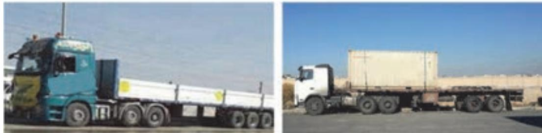
شکل ۲۲- تریلی پنج محور (هجدہ چرخ) و شش محور (شانزدہ چرخ)
