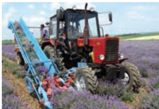
دستگاه تراکتوری برداشت اسطوخودوس
