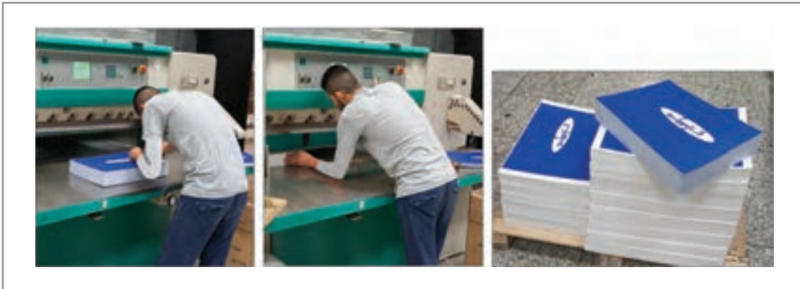
تصویر ۷ برش نهایی، کنترل ابعاد نهایی توسط برشکار طبق دستور کار و ماکت طراحی
