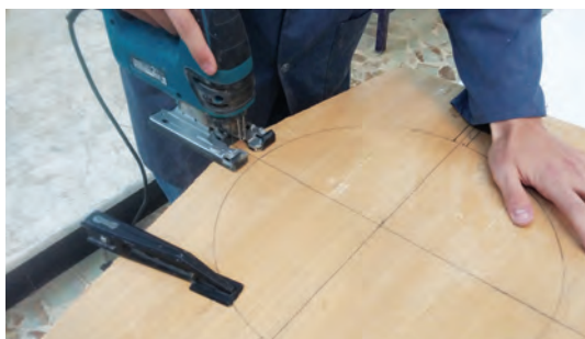
شکل ۵۶- برشکاری از محل اتصال پایه‌ها
