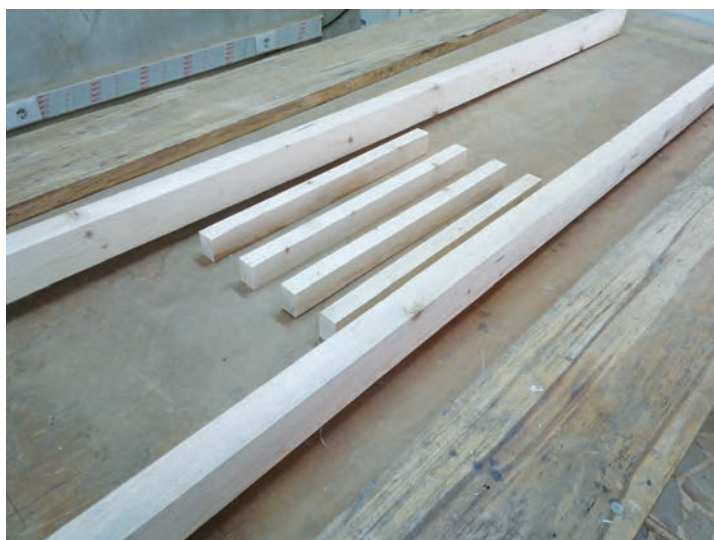
شکل ۳۹- قطعات پاراوان (۲ قید طولی و ۴ قید عرضی)
