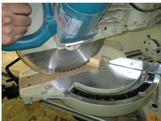
شکل ۲۲- بریدن دو قطعه با هم
