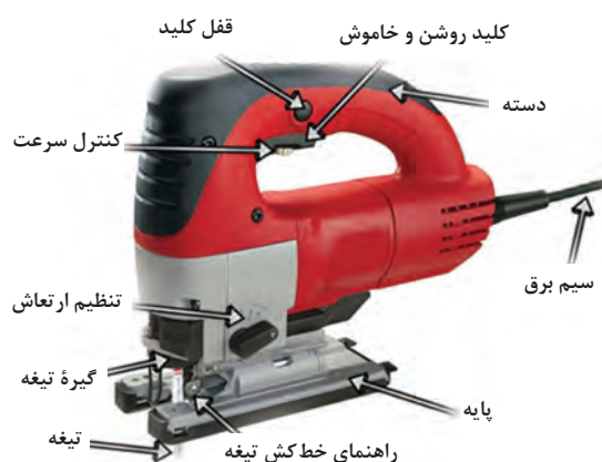
شکل ۴۰- قسمت‌های مختلف اره عمودبر
