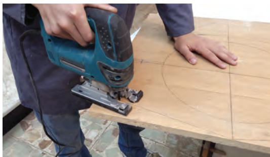
شکل ۵۲- برش حاشیه مورب پایه‌ها
