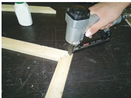
شکل ۲۶-زدن ۲ یا ۳ منگنه در گوشه قاب
