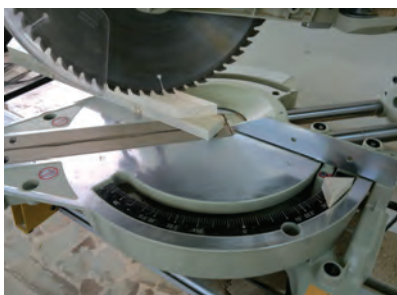
شکل ۲۱- بریدن یک قطعه هم اندازه قطعه دیگر
