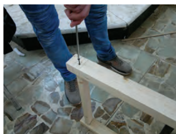
شکل ۵۶- بستن پیچ با پیچ گوشتی دستی
