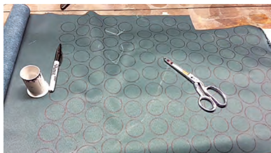
شکل ۶۴- خط‌کشی برای دکمه روی چرم مصنوعی
