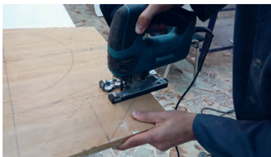
شکل ۵۴- بریدن قطعه کناری تشکیل دهنده نبشی‌ها
