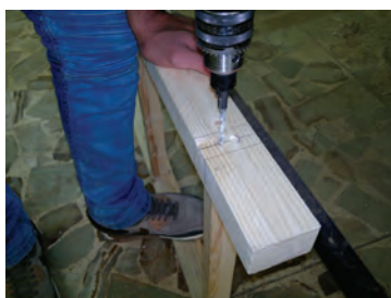
شکل ۵۴- سوراخ کاری جای پیچ دوم
