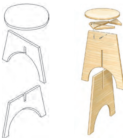
شکل ۳۰- نقشه انفجاری چهارپایه
