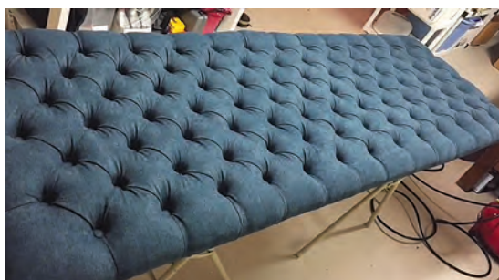
شکل ۷۱-لمسه کاری کامل دیوارپوش تزئینی
