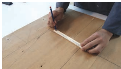
شکل ۳۷- ترسیم دایره بر روی تخته چندلایه
