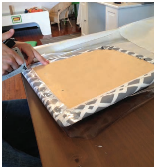
شکل ۷۸- رویه‌کوبی روی تخته
