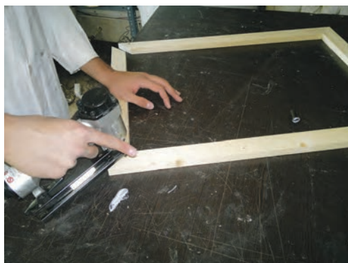
شکل ۲۷-منگنه زدن گوشه‌های دیگر قاب
