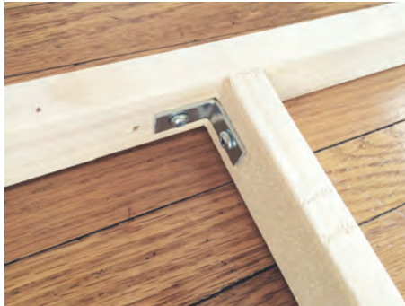
شکل ۲۱- اتصال با بست گونیایی
