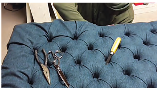
شکل ۷۰-صاف کردن لبه های لمسه
