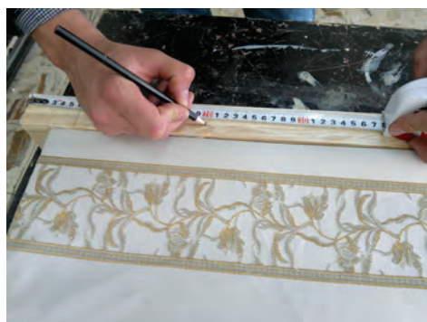
شکل ۶۶- اندازه گیری محل لولا
