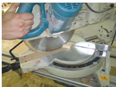
شکل ۲۰- برش فارسی یا ۴۵ درجه باره فارسی بر
