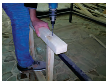
شکل ۵۳- سوراخ کاری با مته خزینه دار
