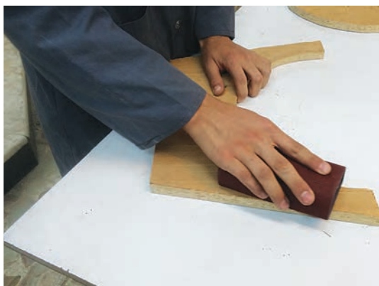
شکل ۶۶- پرداخت کاری با تخته سنباده
