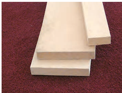
شکل ۱۰- تخته ام.دی.اف بدون روکش
