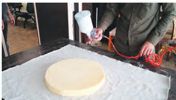
شکل ۸۷- پاشیدن چسب با پیستوله
