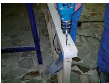
شکل ۵۷- بستن پیچ با دریل
