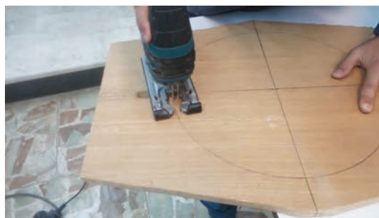
شکل ۶۱- برش کفی دایره شکل
