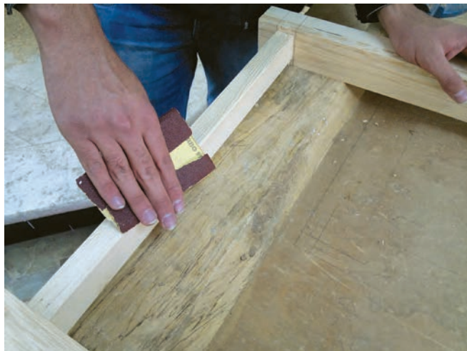
شکل ۶۰- سنباده زدن و گرفتن تیزی لبه‌ها
