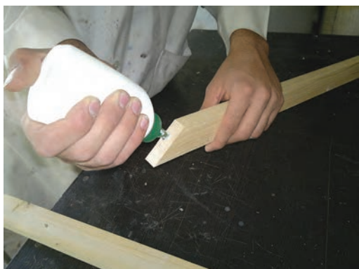
شکل ۲۴-چسب زدن سر قطعات
