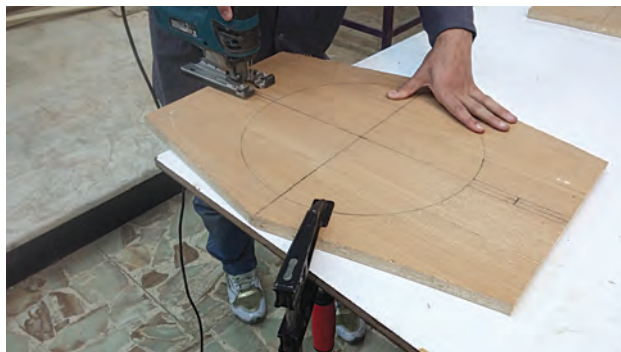
شکل ۴۹- محکم بستن قطعه کار
