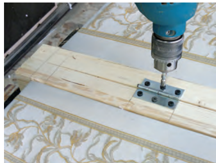
شکل ۷۶- بستن کامل پیچ‌ها
