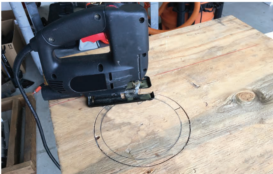
شکل ۵۱- برش داخل قطعه کار
