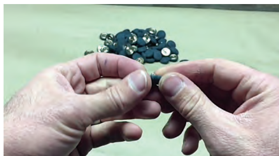
شکل ۶۵- جازدن دکمه قابلمه
