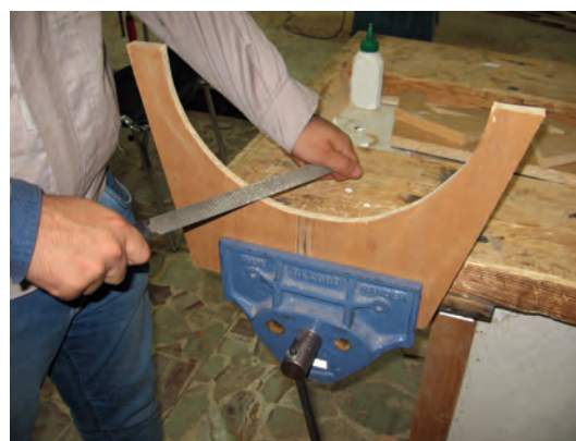
شکل ۶۳- پرداخت با چوبسای زبر
