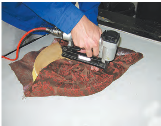
شکل ۱۱۷- منگنه زدن چهارطرف و ثابت کردن پارچه
