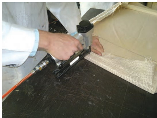
شکل ۳۷- منگنه زدن ضلع آخر قاب
