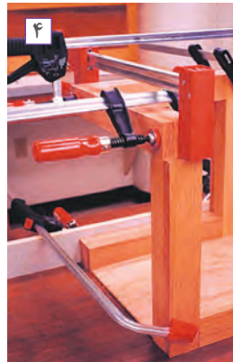
شکل ۲۷- مراحل مونتاژ میز جلوی مبل
