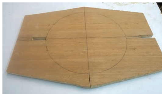
شکل ۶۰- شکاف پایه ها به صورت برش خورده
