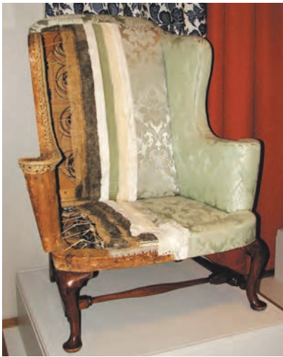
شکل ۶۹- مبلی برش خورده با فنرهای کف
