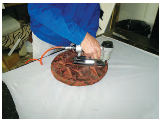
شکل ۱۱۸- منگنه کاری دورها
