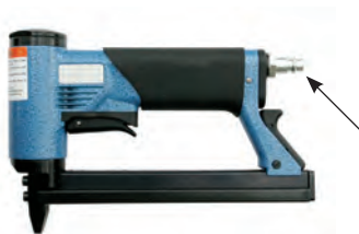
شکل ۹۸- محل اتصال شیلنگ هوا به دستگاه
