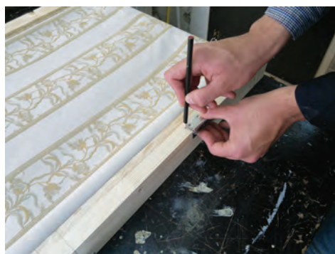
شکل ۶۸- خط کشی با استفاده از لولا
