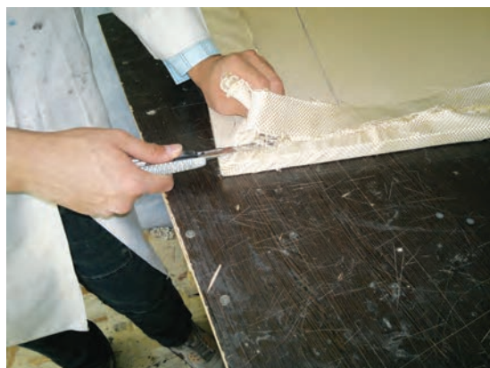
شکل ۳۸- برش پارچه اضافه با کاتر
