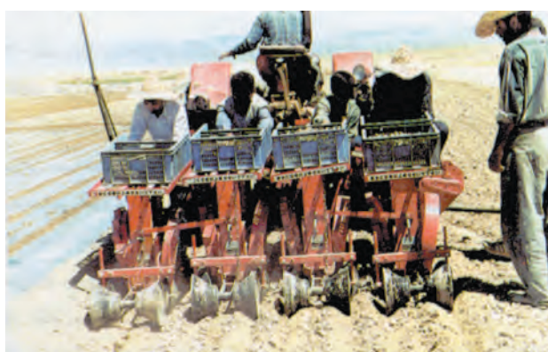
شکل ۱۲-۳- کاشت نشاها با ماشین نشاکار
