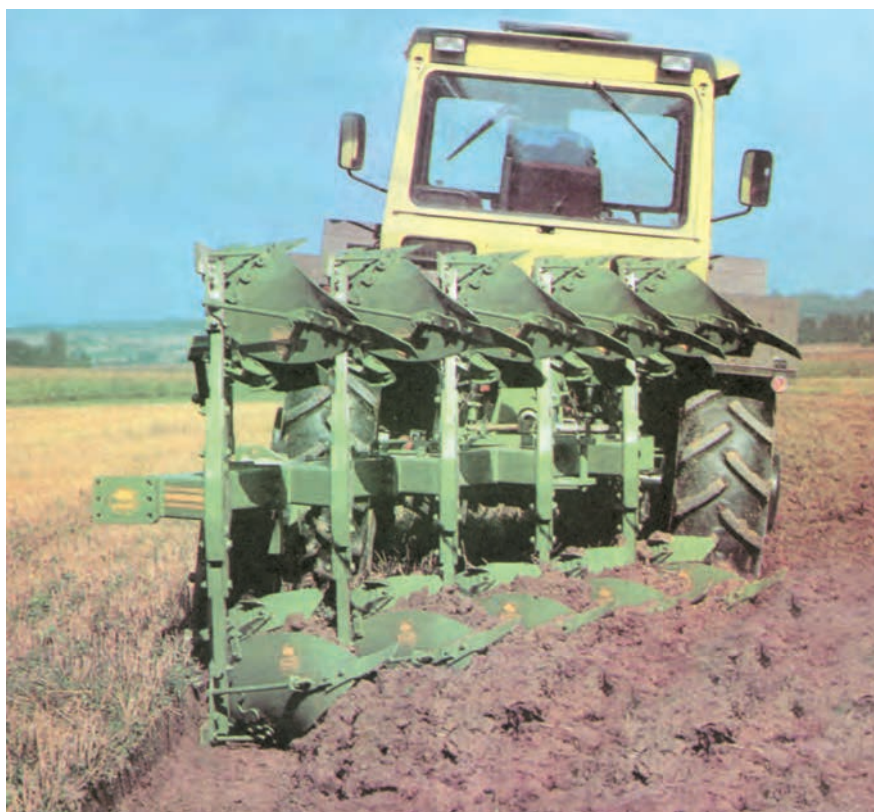
شکل ۵-۲- انجام شخم برای برگرداندن یونجه زار
