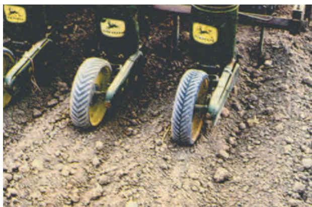
شکل ۵-۳- نحوه تنظیم بذرافشان تراکتوری در اراضی شور
