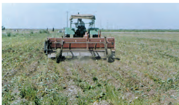
شکل ۱۳-۵- کندن غده‌ها با ماشین
