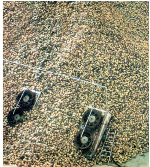
شکل ۲-۶- سیلوی چغندر در کارخانه با کنترل شرایط حرارت و رطوبت
