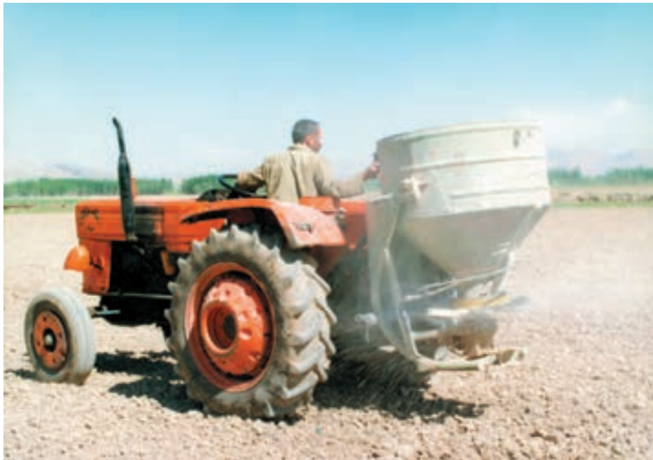
شکل ۸-۴- پخش کود شیمیایی به وسیله کودپاش ساتریفورژ
