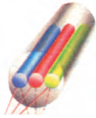
شکل ۹۳-۱- سیستم تولید اشعه In Line
