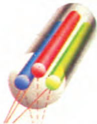
شکل ۹۴-۱- سیستم تولید اشعه \Delta
