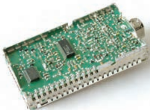
شکل ۲-۳۸- قطعات SMD و آی‌سی‌های روی برد تیونر
