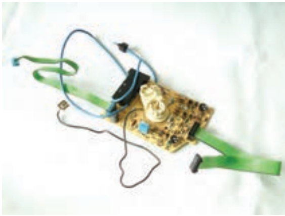
شکل ۱۷۹-۴ سیم ۷ رشته‌ای متصل به بُرد سوکت لامپ تصویر
