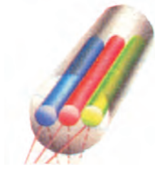
شکل ۹۳-۱- سیستم تولید اشعه In Line
