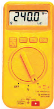
شکل ۱-۶۷- نوعی مولتی متر دیجیتالی
