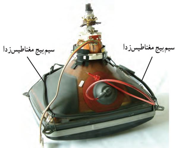
شکل ۱۰۶- سیم پیچ مغناطیس‌زدا در روی قسمت شیپوری لامپ تصویر
