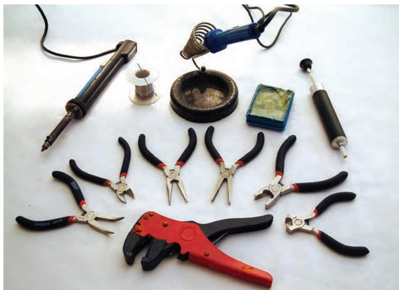
شکل ۱۲۱-۲- برخی از ابزار کارگاه الکترونیک
