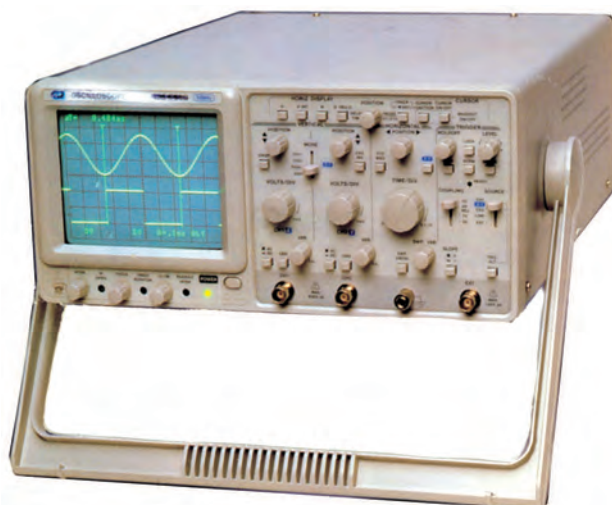
شکل ۲۵-۲ یک نمونه اسیلوسکوپ
