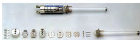
شکل ۱-۷ اجزای یک تفنگ الکترونی
