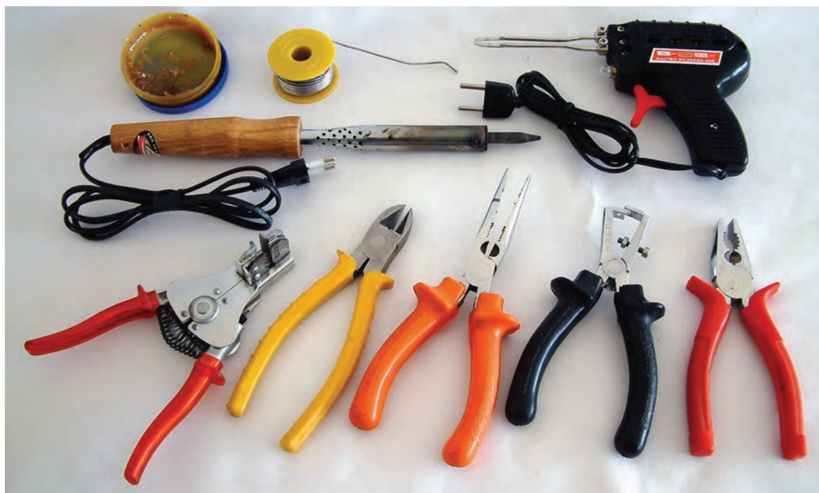
شکل ۱۶۰-۲- برخی ابزار عمومی کارگاه الکترونیک
