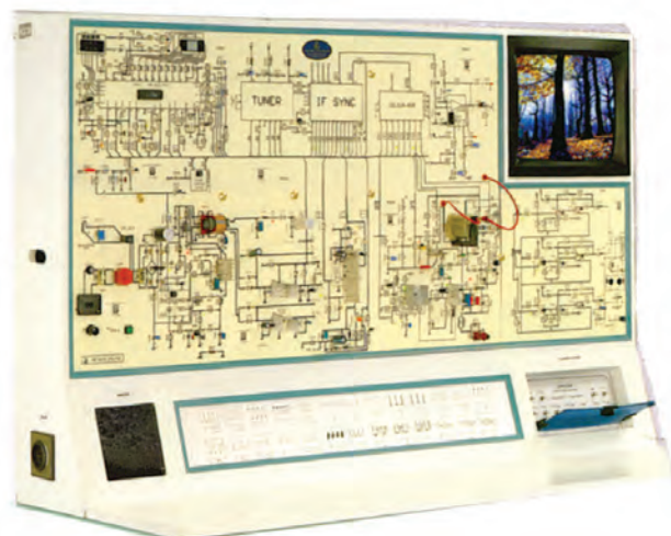
شکل ۱۴۳-۲- یک نمونه گسترده تلویزیون رنگی
