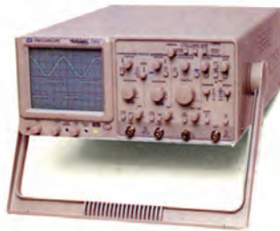
شکل ۲-۷۷- یک نمونه اسیلوسکوپ
