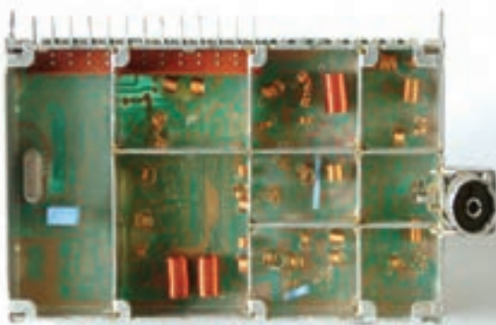
شکل ۲-۴۳- سیم‌پیچ‌های داخل تیونر
