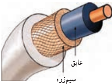
شکل ۴۲-۱ دی الکتریک و زره
