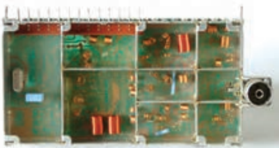
شكل ۳۷-۲- قطعات تیونر
