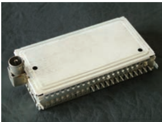
شکل ۲-۲۶- تیونر و پایه‌های آن
