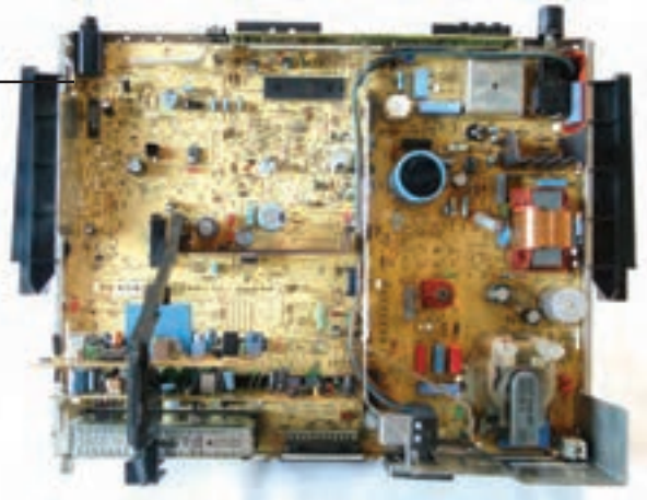
شکل ۳-۲۶- محل نصب آی سی ۳۶۵ در برد اصلی
