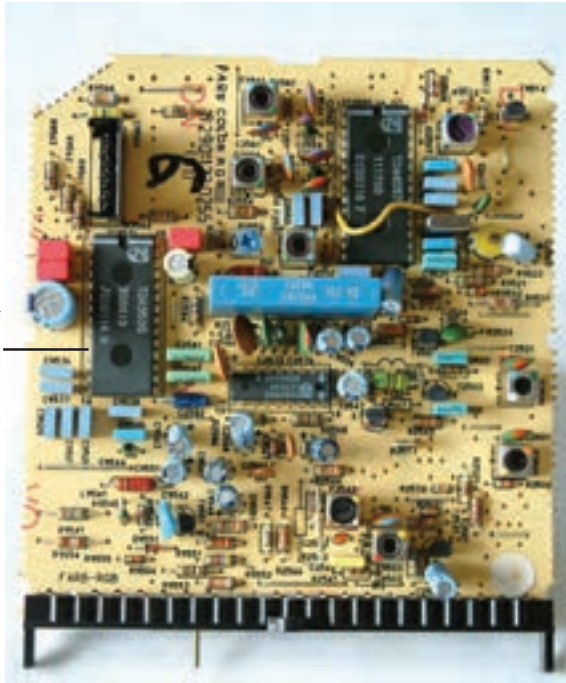
شکل ۴-۱۳۰- محل نصب آی‌سی ۹۵۳۱
