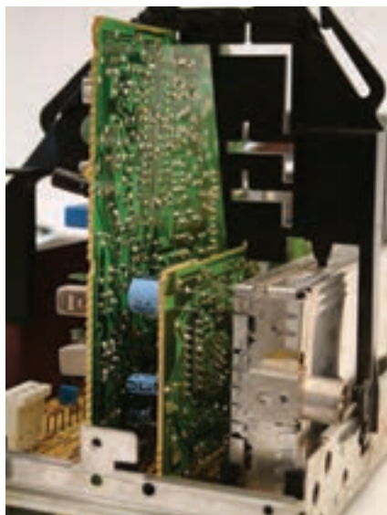
شکل ۱۲۵-۴- مدول RGB روی برد
