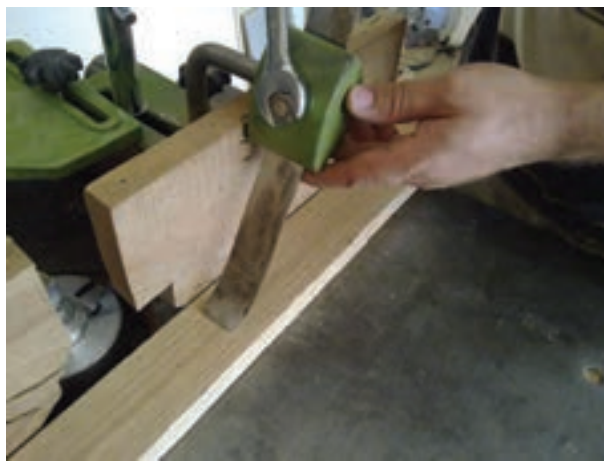
شکل ۲-۲۹- بستن حفاظ فیزی
