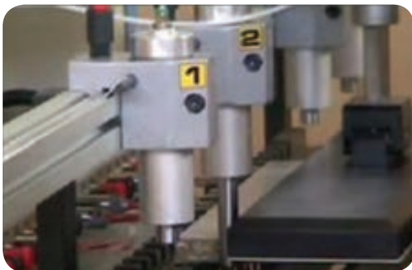
شکل ۳-۷ - قطعه کار، توسط جک‌ها گونبای شده است.
