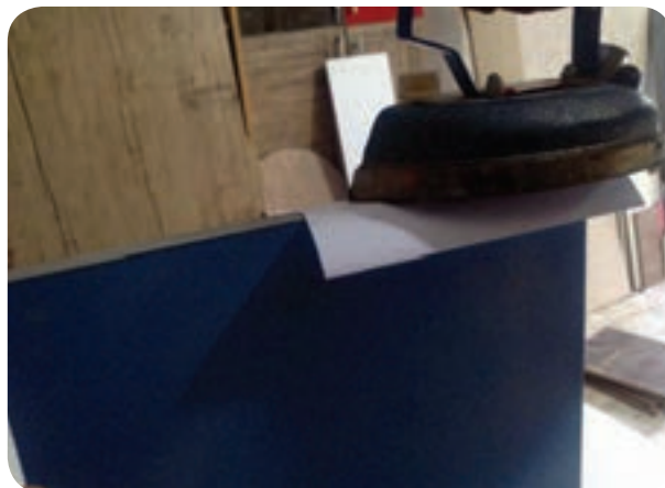
شکل ۴-۴۸- حرکت اتو در روی قطعه کار
