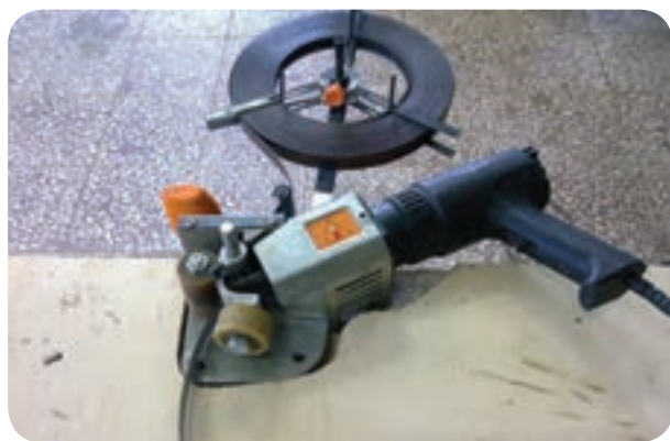
شکل ۴-۲۱ - نحوه استقرار سشوار روی میز
