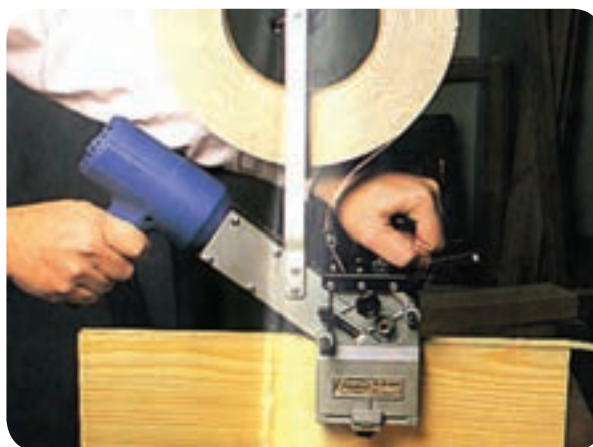
شکل ۴-۱۹ - نحوه نوار کردن با سشوار
