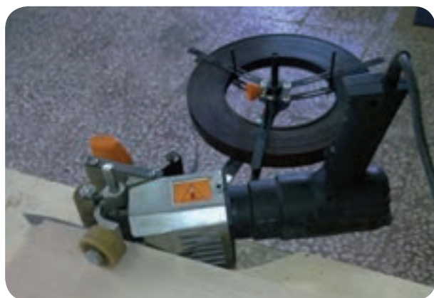
شکل ۴-۲۲ - نحوه نوار کردن قطعه کار به کمک سشوار نصب شده روی میز
