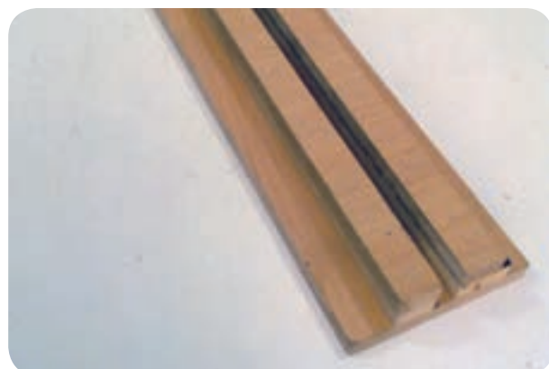
شکل ۴-۲۳ - محل استقرار قطعه کار، برای نوار کردن با اتو یا سشوار
