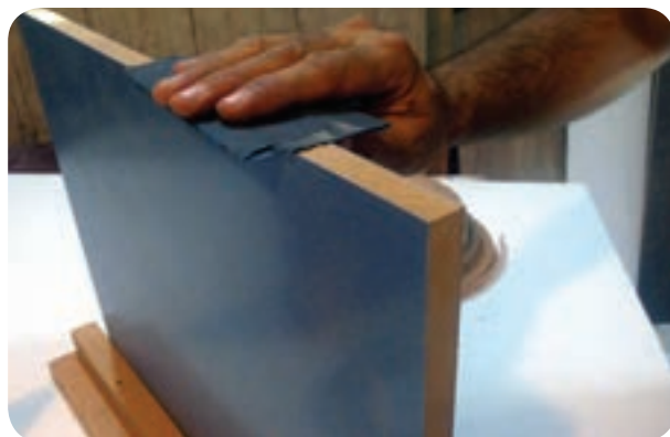
شکل ۴-۴۶- سنباده زدن نوار
