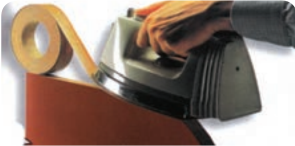
شکل ۴-۱۶ - نوار کردن لبه‌های قوس‌دار توسط اتو
