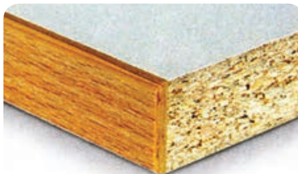
شکل ۴-۲- لبه نئوپان‌ها فاقد زیبایی و صافی هستند.
