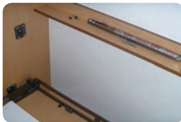
شکل ۵-۱۳۵ جا انداختن محور پایه کلاف فلزی در یراق مربوطه
