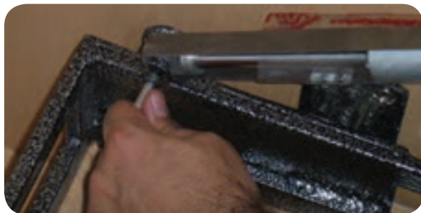
شکل ۵-۱۳۶ محکم کردن پایه‌های جک‌های تختخواب
