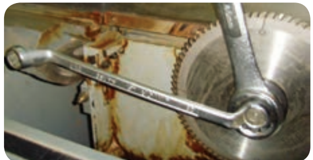
شکل ۵-۵۶- نحوه باز و بسته کردن تیغه اره
