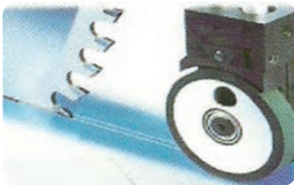
شکل ۳۸-۵- تیغه خطزن مخصوص
