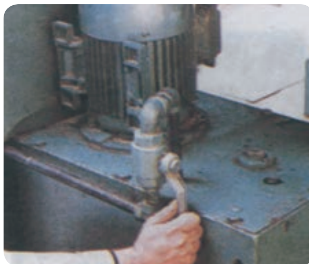
شکل ۷۶-۵- الکتروپمپ و کارترو روغن پرس هیدرولیک
