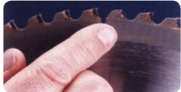
شکل ۵-۴۲ دندانه‌های اره شکسته یا کند شده
