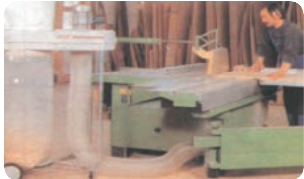
شکل ۵-۲۵- استفاده از حفاظ و تجهیزات ایمنی
