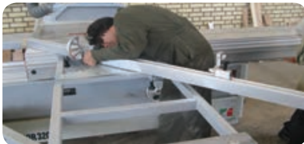
شکل ۵۰-۵- تنظیم دو کفشک کنترل اندازه گیری
