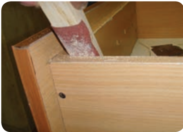
شکل ۵-۱۸۲- برطرف کردن لبه تیز صفحات با سوهان
