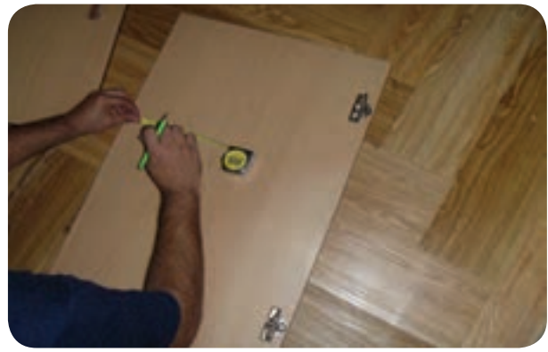
شکل ۱۵۰-۵- نصب لولای در کمد
