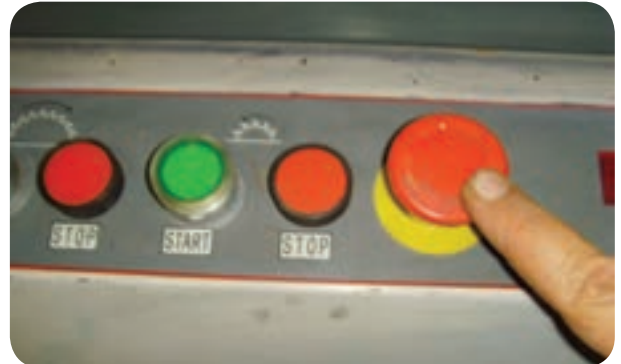
شکل ۵-۶۷- کلید خاموش کردن کلی ماشین دور کن
