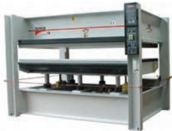
شکل ۹۷-۵- بندهای قطع اضطراری برق پرس در اطراف آن
