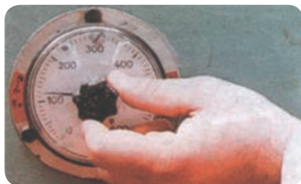
شکل ۷۹-۵- تنظیم فشارسنج پرس
