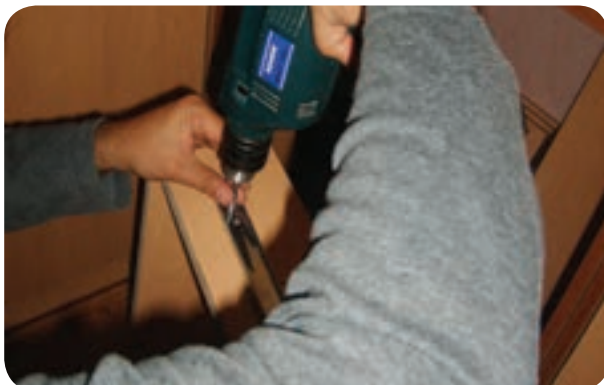
شکل ۱۷۶-۵- نصب ریل تکی به بدنه کشو
