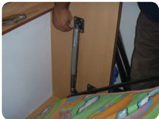
شکل ۵-۱۳۷ تنظیم فشار گاز سیلندر برای تعادل تختخواب
