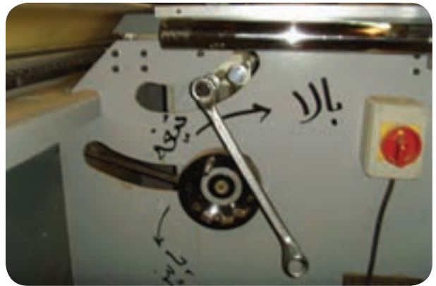
شکل ۵-۵۴- پیچ های تنظیم زاویه خطزن و تیغه اصلی
