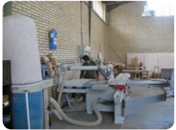
شکل ۵-۵۹- مکنده مناسب ماشین دورکن
