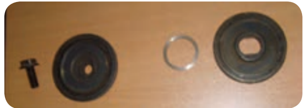
شکل ۵-۵۵- واشر واسطه سوراخ وسط تیغه اره و کفشک ها
