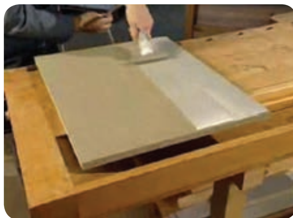
شکل ۹۳-۵- ابزار سرپهن چسب‌زن پنوماتیکی
