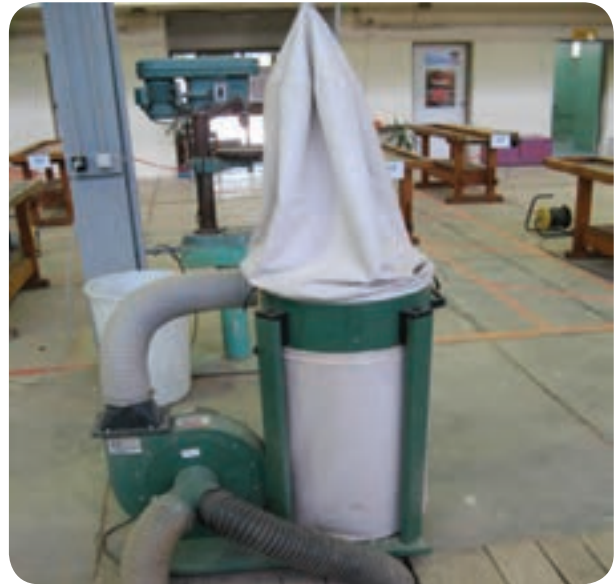
شکل ۵-۲۴- خروج ضایعات از طریق کانال پوشیده شده
