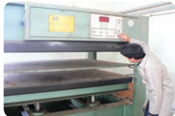
شکل ۸۵-۵: کنترل کار کردن صحیح پرس
