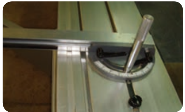
شکل ۵-۵۲- گونیای کوچک قابل تنظیم برای برشکاری
