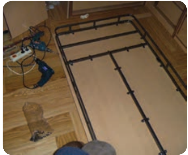
شکل ۱۳۰-۵- استقرار کلاف فلزی روی صفحه جلو تختخواب
