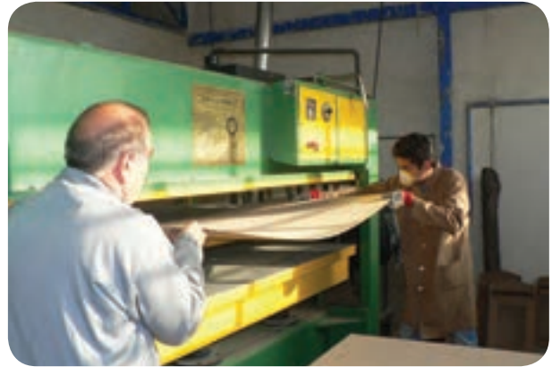
شکل ۹۶-۵- خارج کردن صفحات پرس شده
