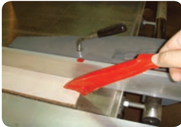
شکل ۵-۶۵- استفاده از وسیله کمکی هدایت قطعه باریک
