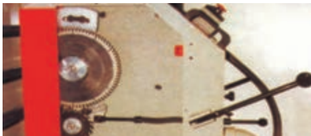
شکل ۳۵-۵- تیغه اصلی و خط زن اره پانل بر عمودی
