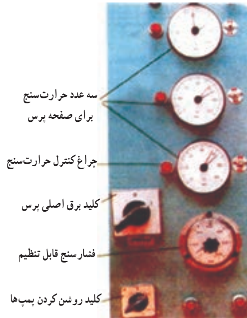
شکل ۸۷-۵- تنظیم اجزای پرس برای چسباندن روکش
