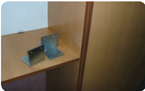
شکل ۱۱۰-۵- بدنه‌های مقر تختخواب از دو ام‌دی اف ۱۶ میلی‌متری
