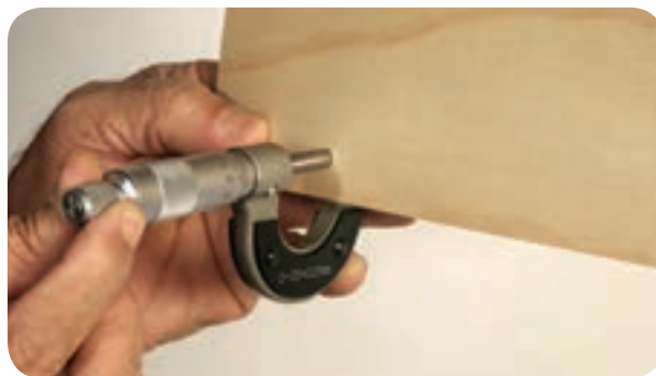
شکل ۷۲-۵ اندازه‌گیری ضخامت روکش با میکرومتر
