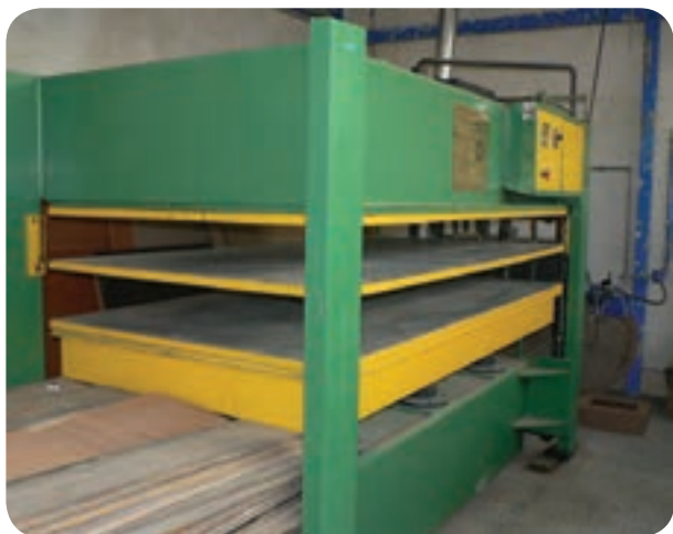
شکل ۷۵-۵ پرس سه طبقه روغنی هیدرولیک گرم
