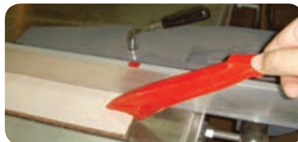
شکل ۱۰۵-۵- هدایت قطعه باریک به وسیله کمکی
