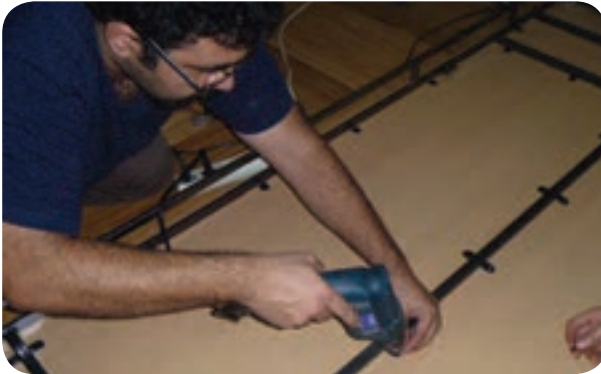
شکل ۱۳۲-۵- محکم کردن کلاف فلزی به پشت در تختخواب
