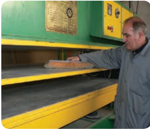
شکل ۹۸-۵- تمیز کردن پرس در پایان کار
