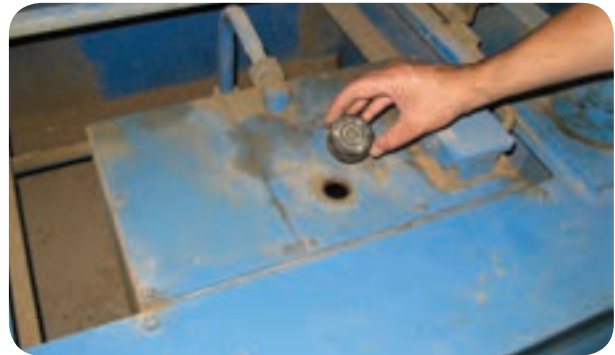
شکل ۸۸-۵- کنترل و تعویض روغن هیدرولیک مخزن
