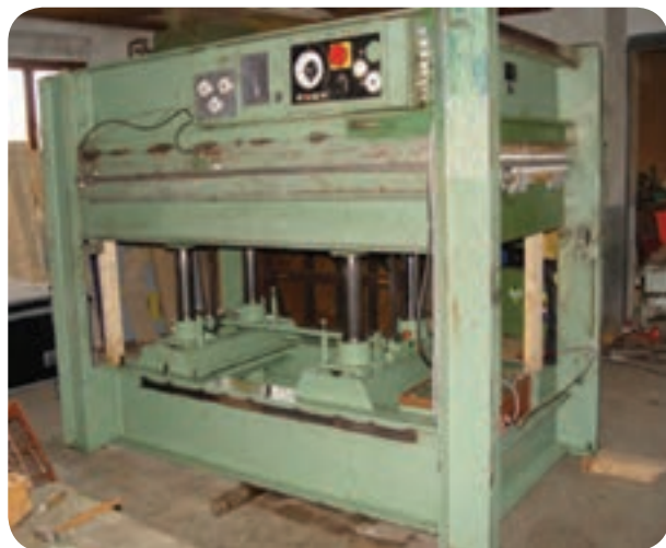
شکل ۷۴-۵ پرس گرم الممتی دو طبقه هیدرولیکی
