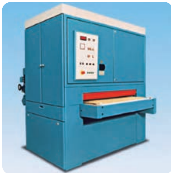
شکل ۷۳-۵ ماشین سنباده نوار غلتکی عمودی
