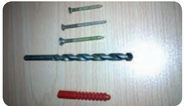
شکل ۶-۵ - مته الماسه، رولپلاک و پیچ های مناسب کار
