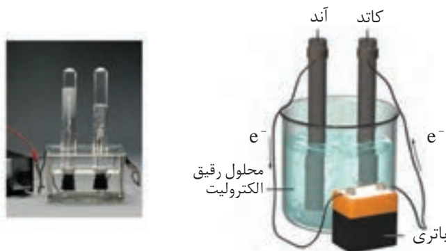
شکل ۱۱- تجزیه آب به عنصرهای سازنده آن با مصرف انرژی الکتریکی
