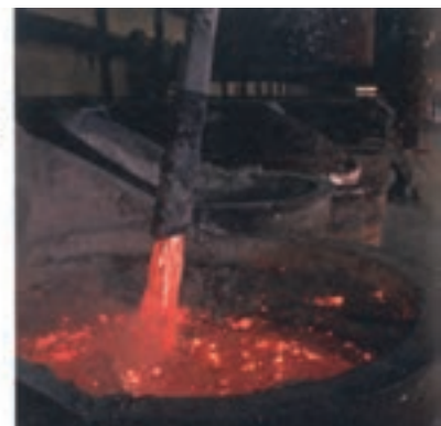
شکل ۱۸- فرایند هال برای تولید آلومینیم از \text{Al}_2\text{O}_3
