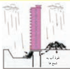
۳- تغییر مکان ناگهانی ساختمان و گسیخته شدن شمع ها در اثر فشار جانبی متغیر
