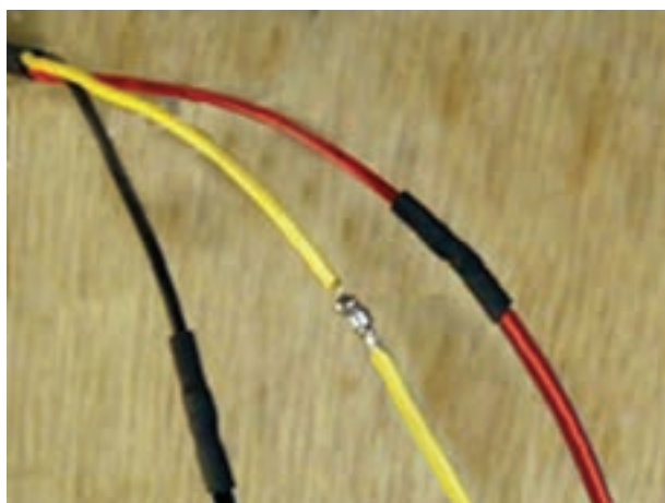
شکل ۱-۷۴- رفع عیب سیم کشی مدار الکتریکی
