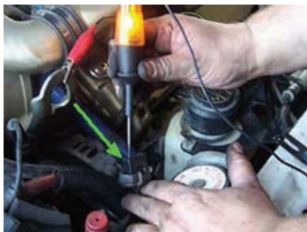
شکل ۱-۷۳- آزمایش سیم کشی مدار
