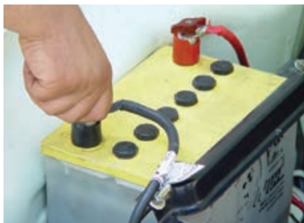
شکل ۱-۴۹- باز کردن اتصال بدنه باتری
