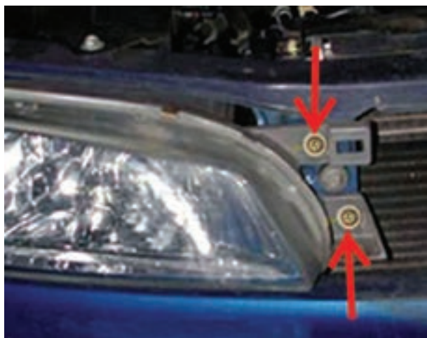
شکل ۱-۴۰- پیچ‌های نگه‌دارنده‌ی چراغ‌های بزرگ جلو
