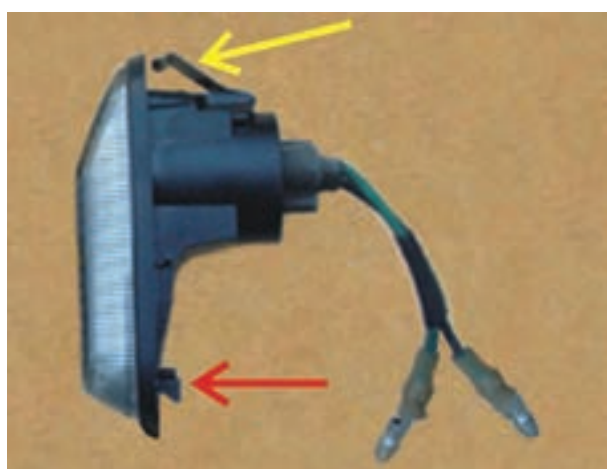
شکل ۱-۶۸- خار و فنر روی کاسه‌ی چراغ
