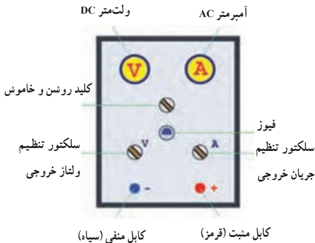
شکل ۴۶-۱- اجزای دستگاه شارژ باتری
