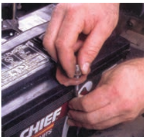
شکل ۹۴-۱- بستن باتری روی خودرو
