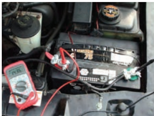
شکل ۱-۶۶ — اندازه گیری ولتاژ باتری
