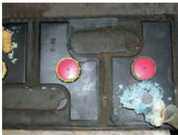
شکل ۱-۷۹ – سولفاته شدن قطب باتری
