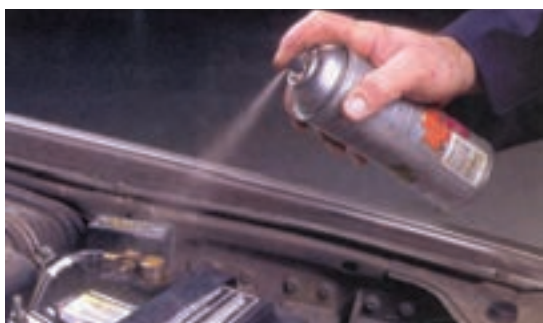
شکل ۱-۹۶- پاشیدن محلول ضد خوردگی روی بست
