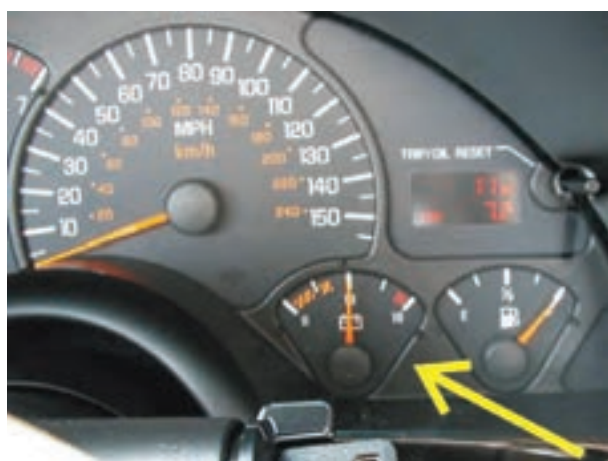
شکل ۱-۷۸ – نشان‌دهنده‌ی وضعیت شارژ باتری
