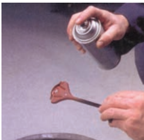
شکل ۹۳-۱- اسپری ضدخوردگی روی بست نگه‌دارنده‌ی باتری
