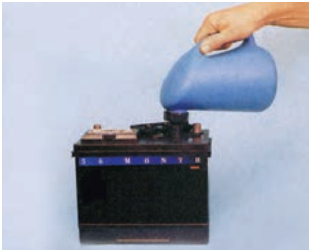
شکل ۱-۲۷ - پر کردن خانه‌های باتری نو با الکترولیت
