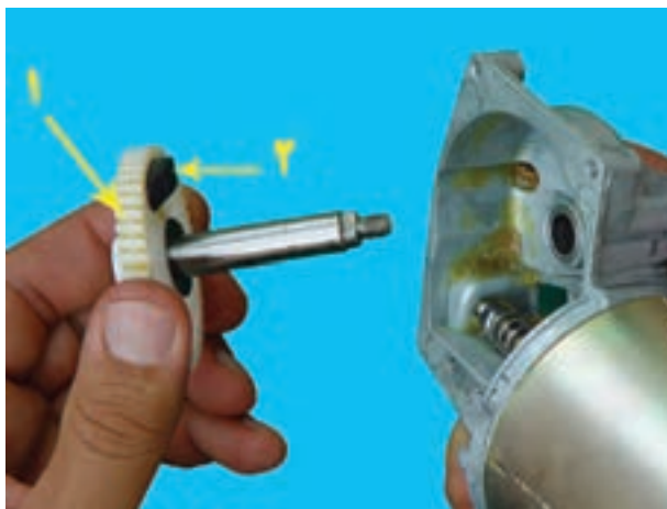
۱- چرخ دنده ۲- بادامک محرک زائده پلاتین
