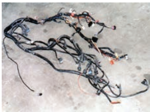
شکل ۱۳۳-۱- دسته‌ی سیم‌های یک نوع خودرو
