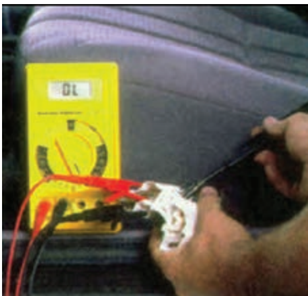
شکل ۹۸-۱ آزمایش حالت استپ موقت دسته ی راهنما
