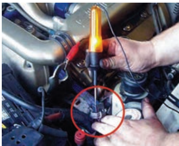
شکل ۱۴۵-۱- آزمایش برقراری جریان مدار چراغ‌های روشنایی
