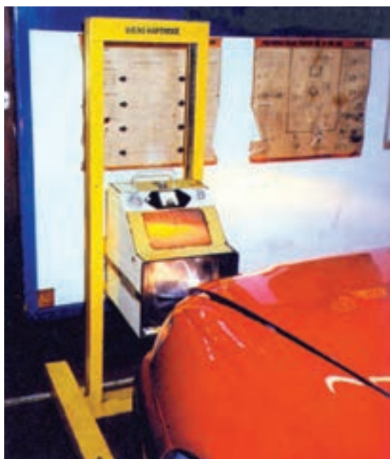
شکل ۱-۱۵۳- یک نوع دستگاه تنظیم نور چراغ‌های بزرگ
