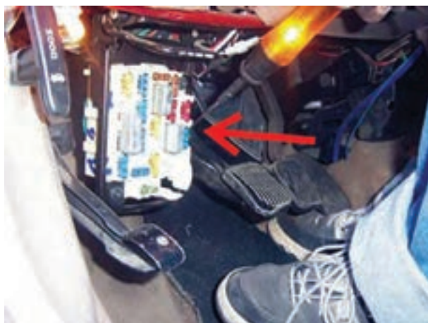
شکل ۱۲۰-۱ آزمایش جعبه‌ی فیوز با چراغ آزمایش
