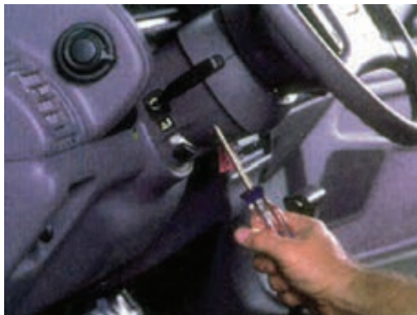
شکل ۱-۹۰- باز کردن پیچ‌های قاب سوئیچ روشنایی
