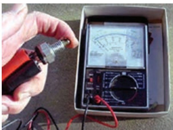
شکل ۱۰۵-۱- آزمایش سوئیچ چراغ‌های دنده عقب
