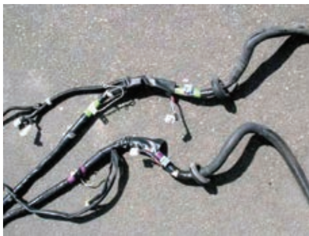
شکل ۱۳۷-۱- کلاف سیم کشی یک نوع خودرو
