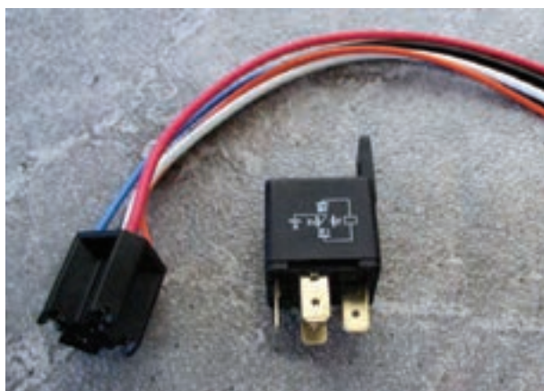
شکل ۱-۱۲۲- یک نوع آفتامات مدار الکتریکی خودرو
