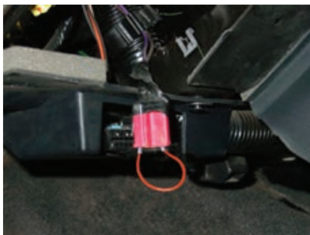
شکل ۱-۱۲۹- یک سره کردن مدار راهنما
