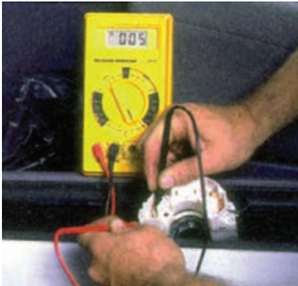
شکل ۹۷-۱ آزمایش سوئیچ روشنایی
