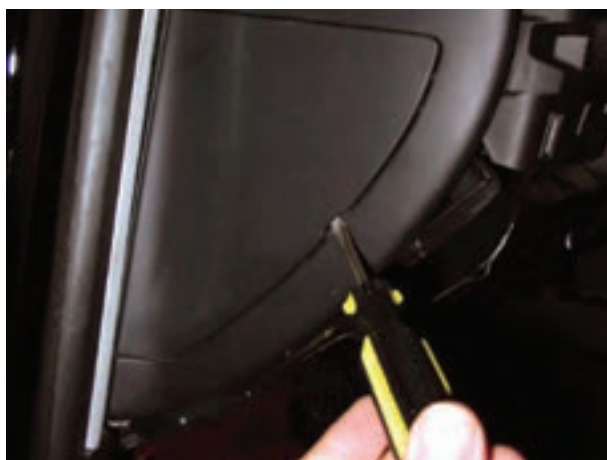
شکل ۱۱۸-۱ آزاد کردن خار پوشش محفظه‌ی جعبه‌ی فیوز
