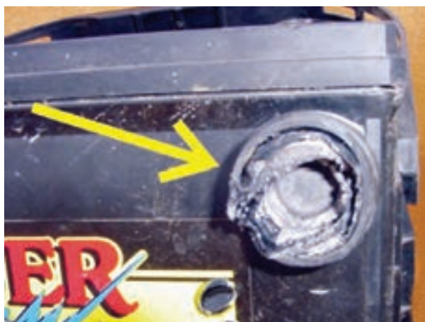
شکل ۳۶-۲- معیوب بودن ترمینال باتری
