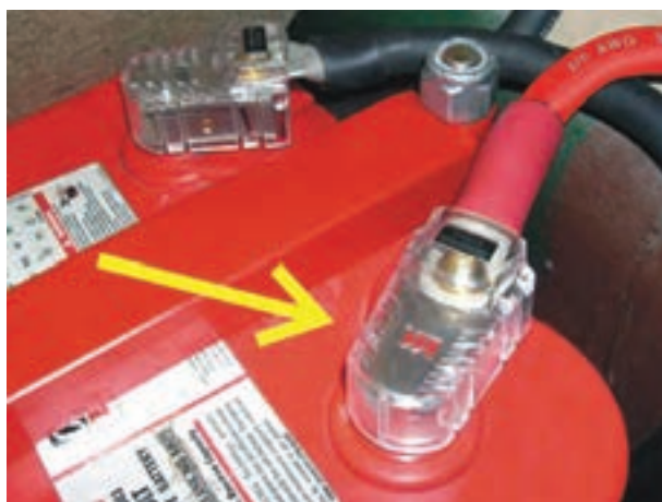
شکل ۱۹-۲- مورد استفاده تلق محافظ قطب‌های باتری
