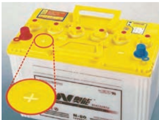
شکل ۲-۹- کاربرد علائم برای تشخیص قطب‌های باتری
