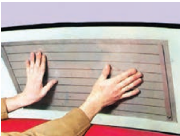
شکل ۹-۳- نحوه چسباندن المنت حرارتی
