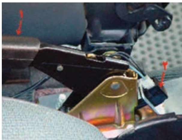
شکل ۲۰۲-۱- سوئیچ ترمز دستی ۱- اهرم ترمز دستی ۲- سوئیچ ترمز دستی
