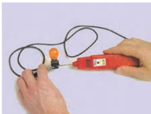
شکل ۱۸۲-۱- آزمایش لامپ چراغ راهنما
