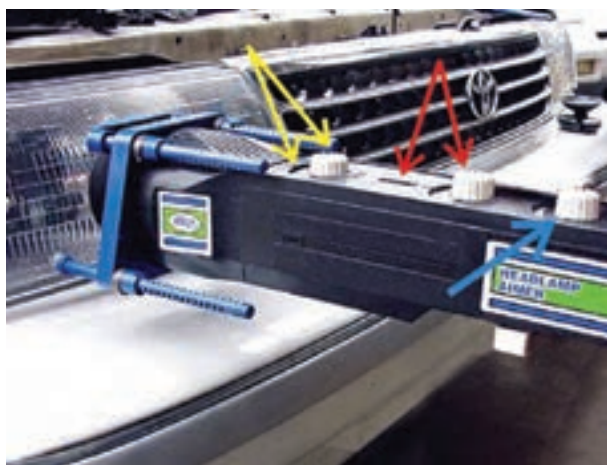
شکل ۱۶۱-۱- پیچ‌های تنظیم دستگاه تنظیم نور چراغ‌ها
