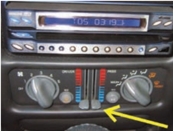
شکل ۴-۵۴- اهرم‌های تنظیم هوای ورودی
