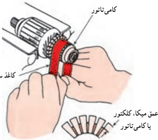
شکل ۴۵۰-۴- با کاغذ سنباده هرگونه عایق جزئی را برطرف و با تیغه اره عمق شیار کامی تاتور را اصلاح کنید.
