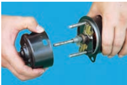
شکل ۴۵-۴ جدا کردن پوسته‌ی موتور
