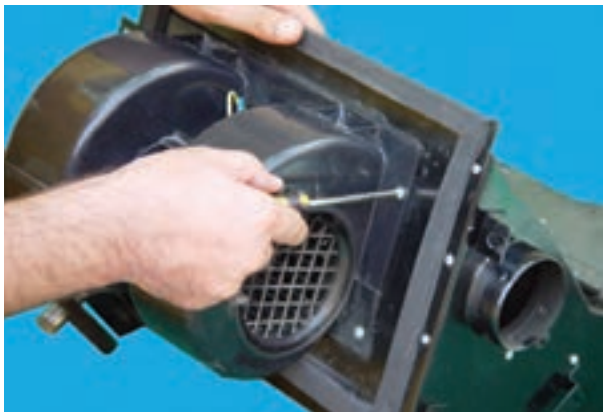
شکل ۳۶-۴- باز کردن پیچ‌های محفظه‌ی موتور
