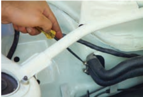
شکل ۴-۳۱- باز کردن لوله های آب رادیاتور بخاری
