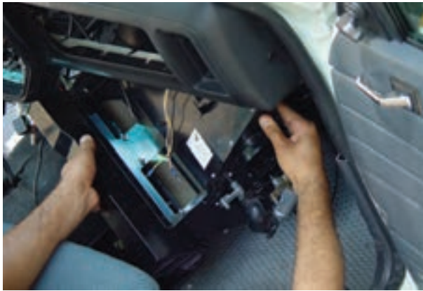
شکل ۳۴-۴- خارج کردن بخاری از محل نصب آب
