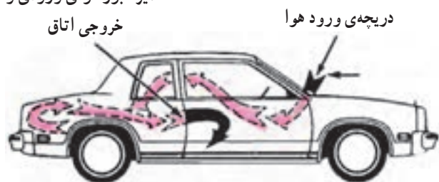
شکل ۴-۱۱- مسیر عبور جریان هوای گرم در خودرو
